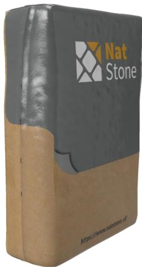
Mortero para maquillaje NatStone M-10 es un mortero predosificado basado en cemento con áridos seleccionados, aditivos específicos, especialmente formulado para realizar maquillaje y afinados en muros de hormigón, disimulando imperfecciones. Este producto puede ser aplicado en espesores de 2 mm hasta los 10 mm. y puede ser talochado.
