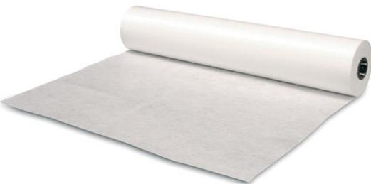
NatStone Geotextil es un material no tejido, diseñado específicamente para reforzar áreas críticas en proyectos de impermeabilización de superficies. Su estructura de 40 g/m<sup>2</sup> destaca por su elevada resistencia a ambientes alcalinos. Con un alto contenido de celulosa, facilita una óptima impregnación del impermeabilizante aplicado, ofreciendo un refuerzo confiable y duradero en los puntos de encuentro clave.
